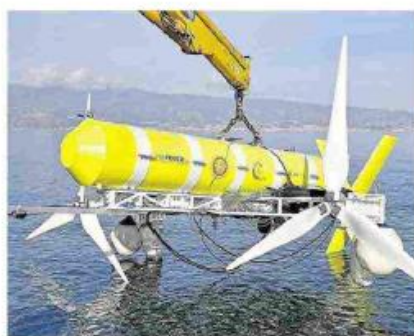
Sopra GemStar, definito "l'aquilone del mare" che sfrutta le correnti Sotto Pivot, trasforma il movimento delle onde in elettricità
